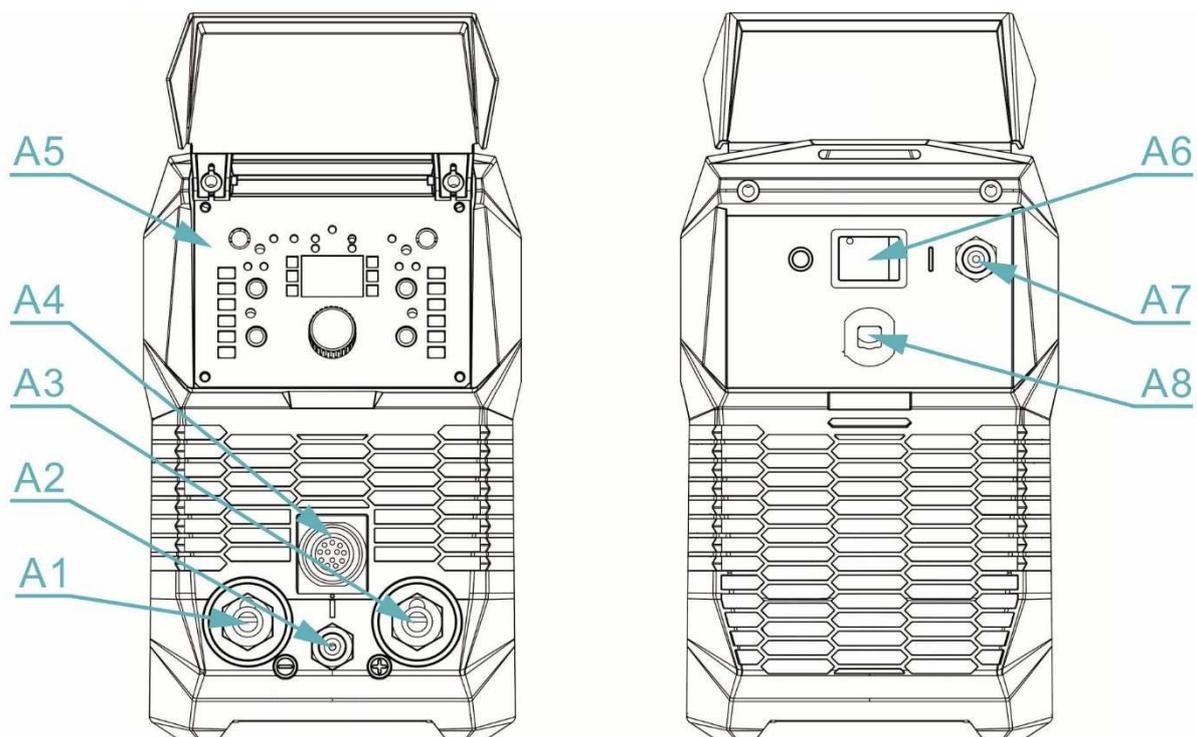
Obrázek 1. Hlavní části stroje, přední a zadní pohled
