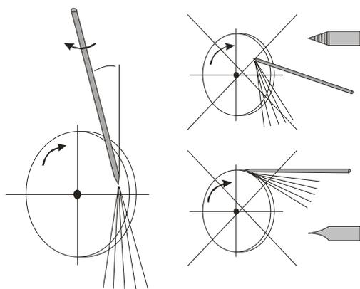
Obrázek 8. Broušení W elektrody, vlevo správně, vpravo špatně
